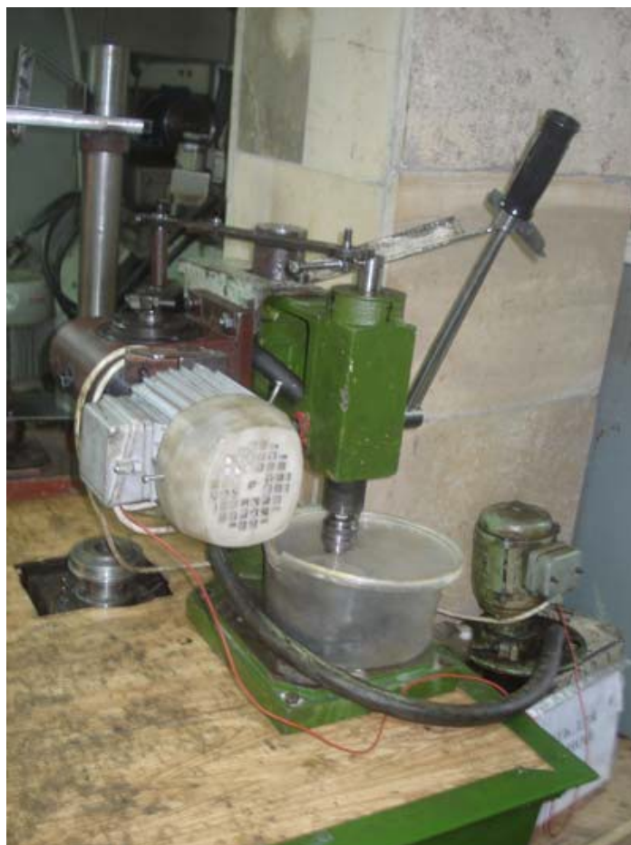
Рис.6. Фотография установки для испытания подшипников на сопротивление загрязнению
