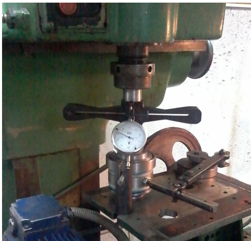
Рис. 1 - Фотография стенда для ресурсных испытаний подшипников 1118-2902840-04
