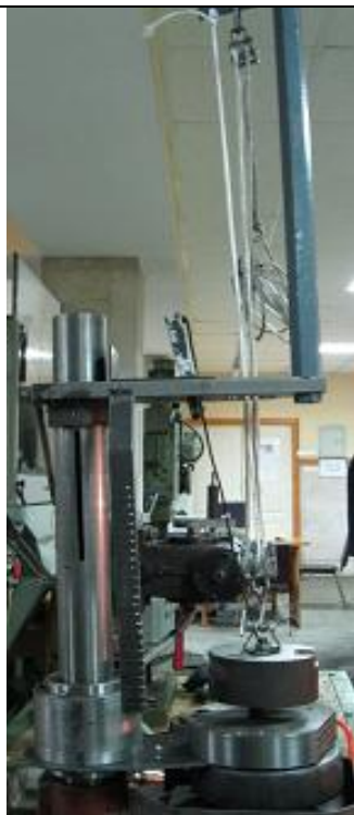
Рис. 5 Фотография установки для испытания на сопротивление удару
