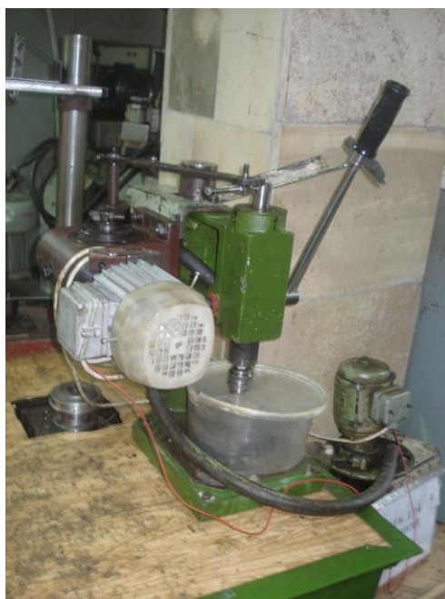
Рис. 6– Фотография установки для испытания подшипников 1118-2902840-04 на сопротивление загрязнению
