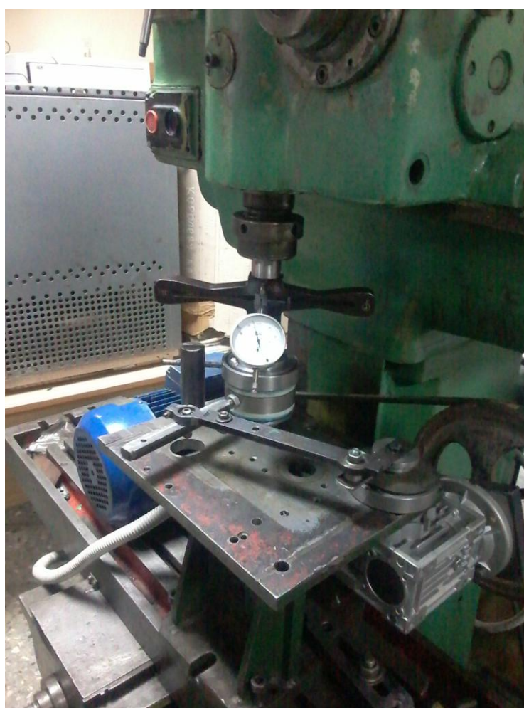
Рис. 1 Стенд для ресурсных испытаний подшипников
